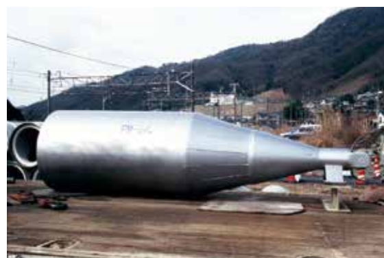
写真-1 HPφ450mmクラッキングヘッド
