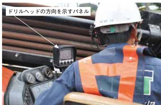
写真-5 ドリルマシンの操作パネル
