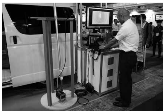
▲ 坑内点検用カメラ
