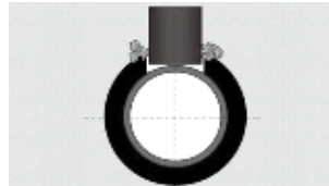
損傷パターンⅢ 欠陥（漏水）接続（本管軸に45°で本管天端と側方の中間にて接続）
