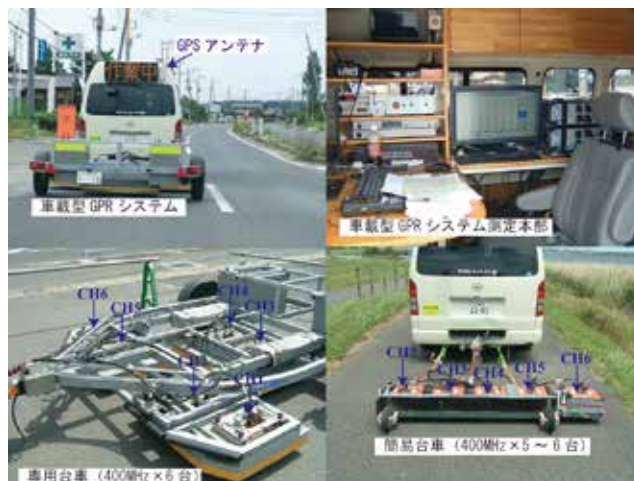
写真-1 車載型 GPR システム
