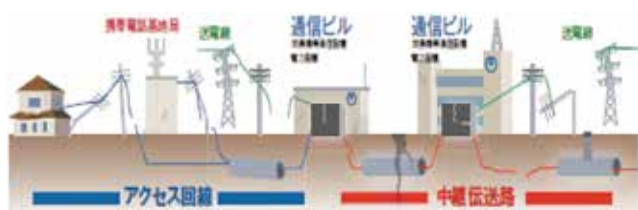
図－1 通信ネットワークの構成と被災箇所
