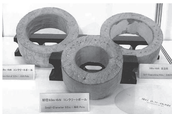
写真－5 コンクリート柱断面
