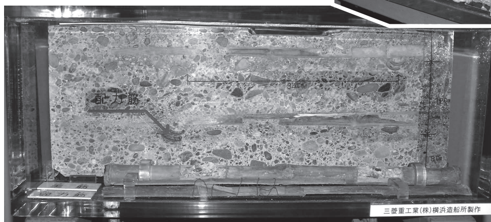
写真－2、3 竹筋コンクリートの実物（横浜の県道の橋梁で使用されたもの）
