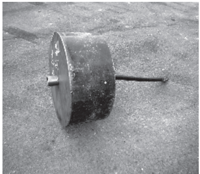
写真-2 鋼管先端モルタル吐き出し部
