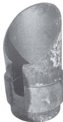
写真-4 今回の現場で破碎している既設ポリエチレン管の一部
