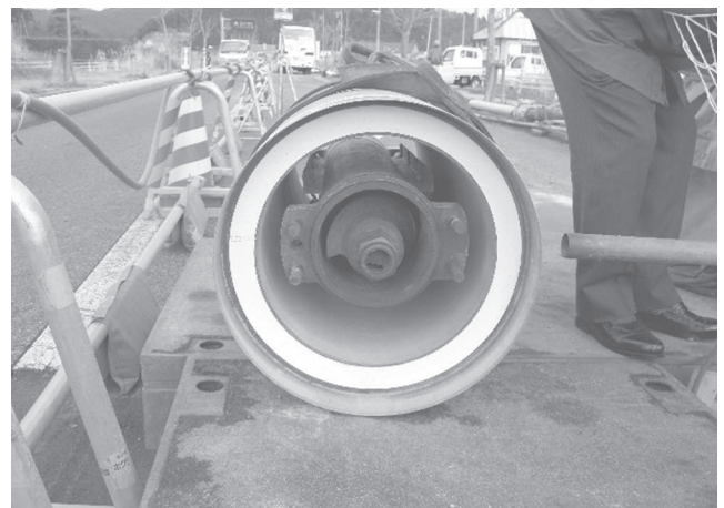
写真-11 切削片は中央のオーガーで排出される
