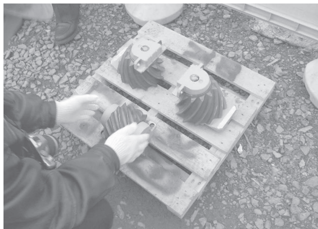
写真-14 SUSカラーをも切断する特殊カッタ
