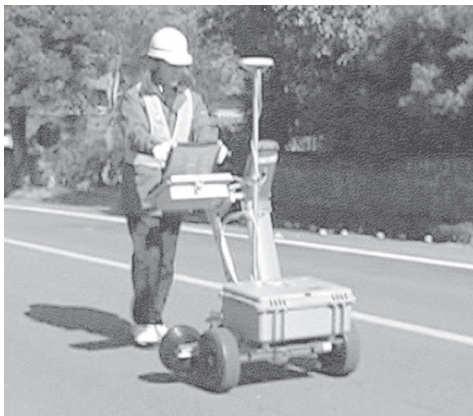
写真-1 ケーブルエクスペローラーでの計測状況
