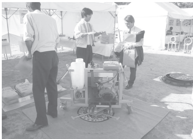
写真－12 摩耗したマンホールの蓋を取り替えます
