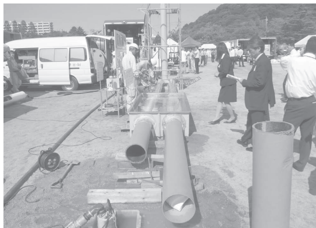
写真-8 途中の水槽は地下水位が高い場所を模擬
