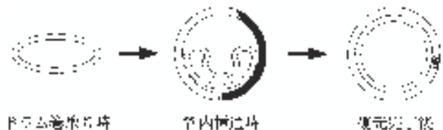
図-3 PE管変形状況
