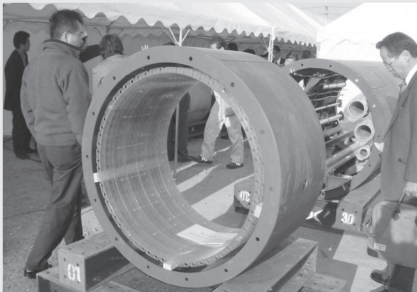
デュアルシールド工法公開実験（関連記事 p.66） シールド箇所施工後3Sセグメントで2次覆工
