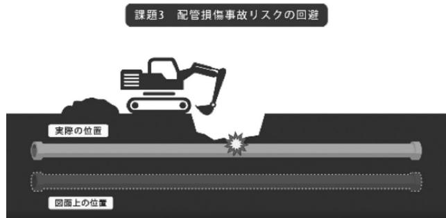
図-7 配管損傷事故リスクの回避技術紹介
