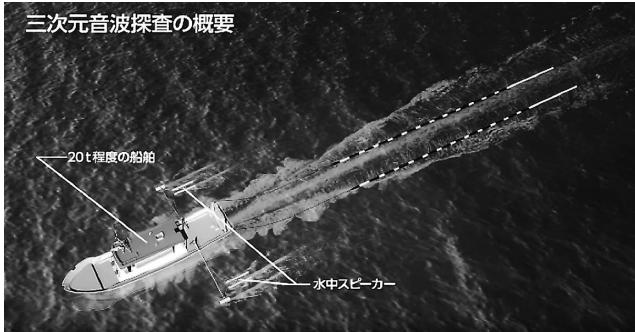
図-11 3次元音波探査の概要紹介
