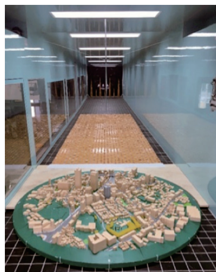
写真-6 風洞実験棟(エッフェル型吹出式境界層風洞装置)
