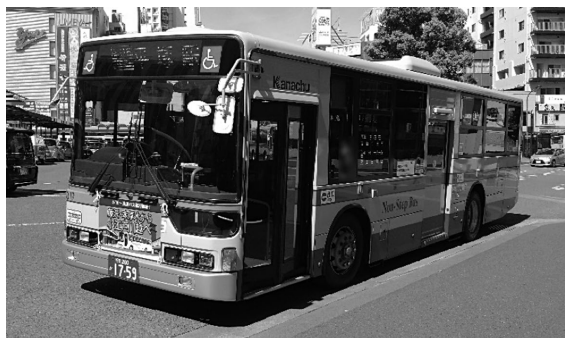
■ 神奈川中央交通（三菱 エアロスター QKG-MP37FK） 助手席側フロントガラスの下にある視野拡大窓（セーフティウィンドウ）がエアロスターの特徴であるが、神奈川中央交通としては2013～14年式の一部車両のみの比較的珍しい形態である
