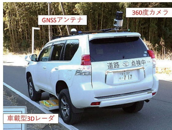
写真-1 路面下空洞調査使用車両
