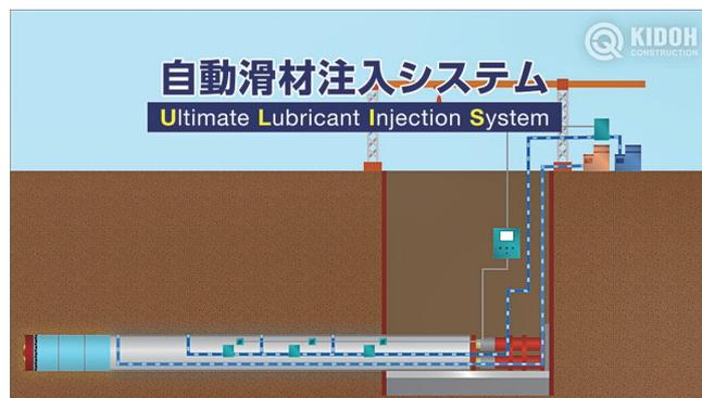
図-1 ULIS 模式図 (自動滑材注入システム)
