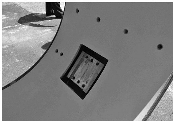
写真-4 掘進機外殻の内側
