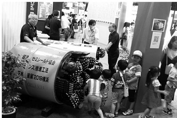
▲ 巨石・岩盤破砕型掘進機（長寿命型）
