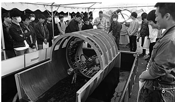
通水しながらの施工が可能なので水槽内で実施
