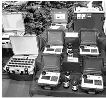
写真-4 自立型電気探査装置
