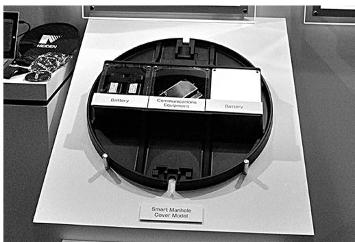
写真-3 マンホールアンテナ
