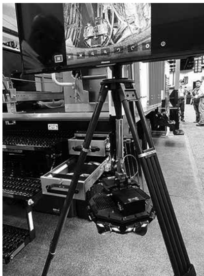
写真-4 人孔調査カメラ
