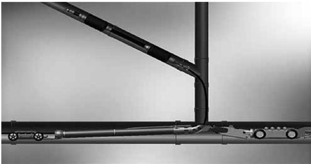
IMSロボティクス社は、家庭からの排水管を、私有地に立ち入らずに修繕できるIMS下水道取付管システム(STLシステム)を開発した。このSTLシステムは、下水道本管から取付管や排水管に入り、穿孔、洗浄、検査などの修繕作業を行うことができる。
