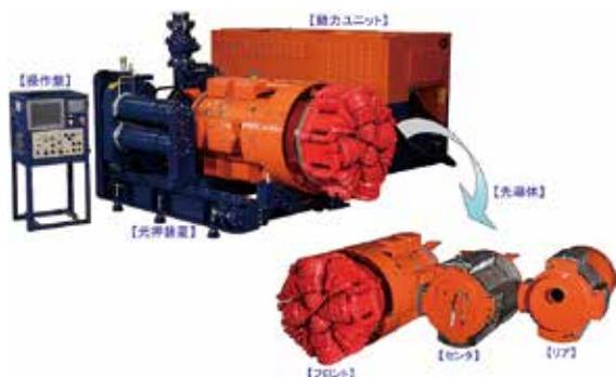
写真-1 エースモールDL70-Cの構成
