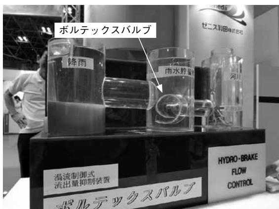
▲ (写真-1) 流出量抑制装置
