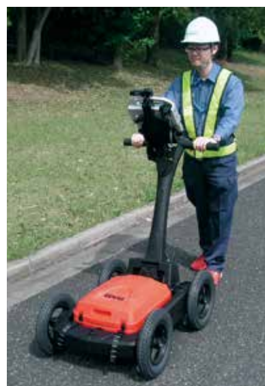
写真-1 埋設物探査用地中レーダー
