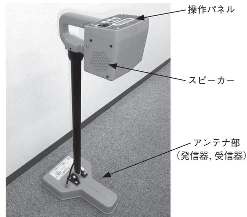
写真-1 探査装置本体
