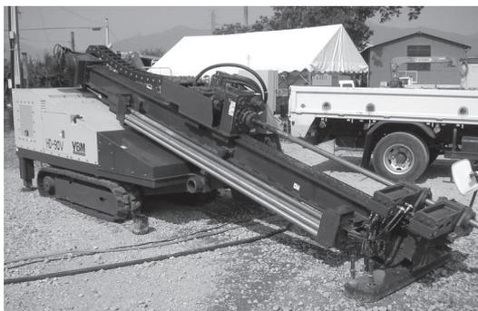
①パイプロHDD工法【誘導式水平ドリル工法】
