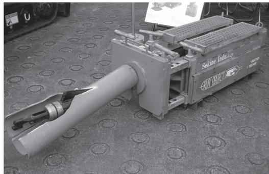
④グルンドバースト工法【破碎・拡張式推進工法】
