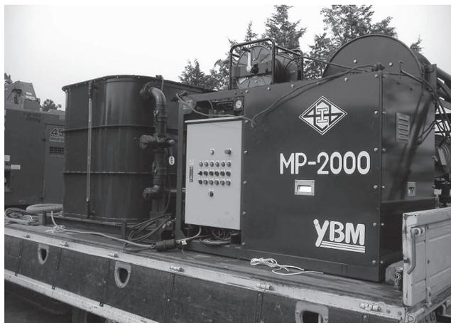
写真-3 削孔水ユニットMP-2000
