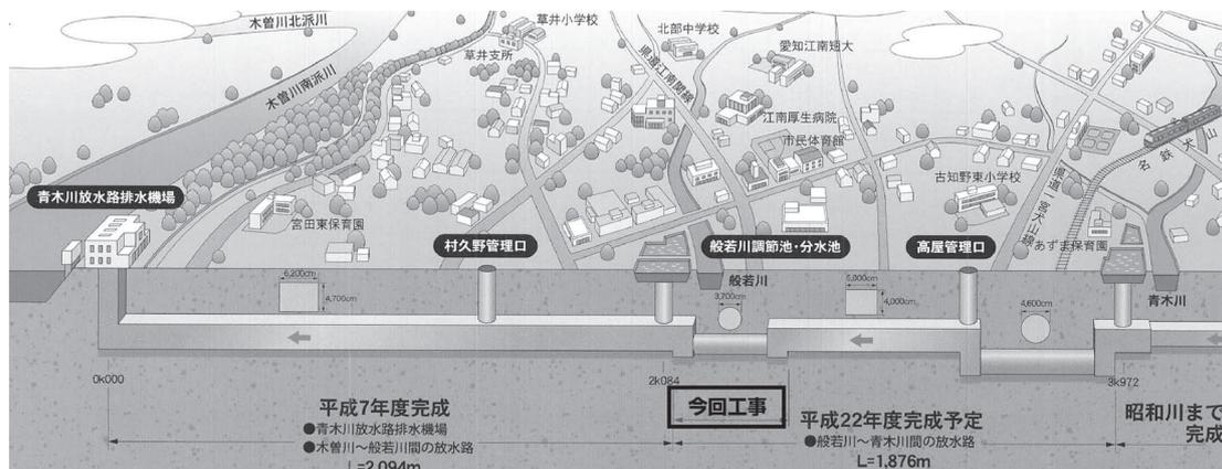
図-1 青木川放水路計画概要（資料提供：当該工事パンフレットより）
