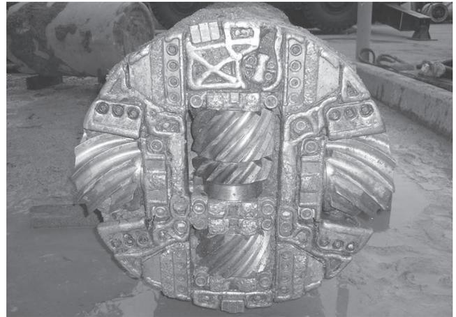
写真-8 テスト推進後カッターヘッド
