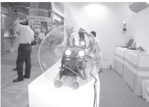
小口径管推進工法の曲線測量装置は磁力線方式、ジャイロ方式、ワイヤー方式、プリズム方式と様々な試みがされているが、今年は新たにCMOSカメラ方式が登場した。原理は、曲線路線に応じてあらかじめ既知の距離にセットしたCMOSカメラとターゲットが組まれた複数の「計測センサ」間の角度を画像処理により演算処理、先端のマシンの位置と方向を計測するシステムであり、プリズム方式と似た原理である。現在φ350以上の管径に対応可能であり、更なる小型化とコストダウンが課題とのことである。
