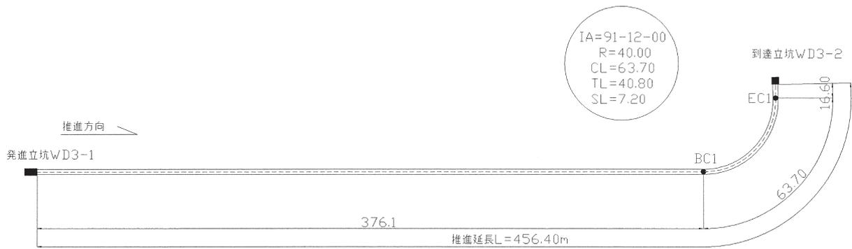
図-2 台湾電力公司：φ 2400mm急曲線推進工事
