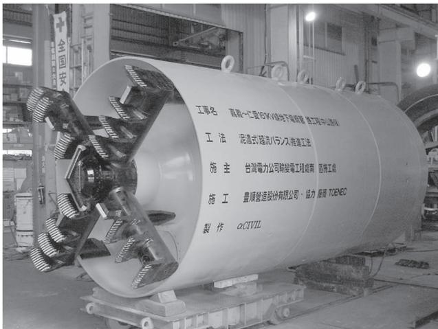
写真-3 φ1800mm泥濃式掘進機
