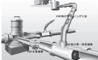
基本的にはCR管更生システムやASS工法などと同じ部分補修工法であるが、取り付け管接合部付のライナー材や、取付管ライニング工法を組み合わせ、マンホールからマンホールまでのすべての管更生に対応できる。熱硬化系と光硬化系のライナー材があり、本管内径150～700mm（補修幅40cm）と内径
