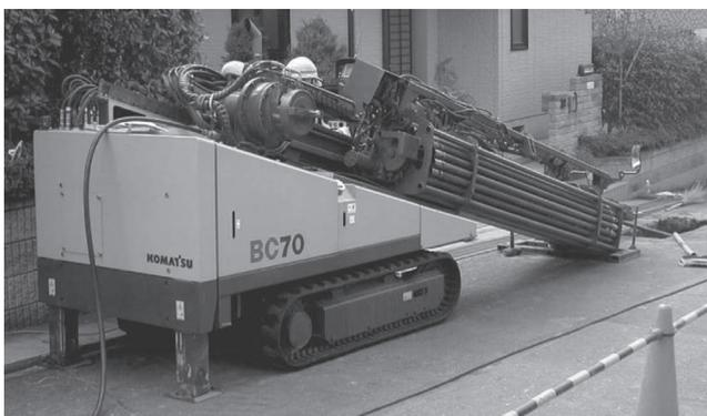
わが国最初のHDD（誘導式水平ドリル）工法専用機である。わが国の施工環境を考慮して、輸入機にはないコンセプトを持っている。例えば狭い路地でも施工できるコンパクト設計であり、騒音公害に対する静粛設計であり、操作の容易性である。また、タッチパネル式操作盤やロッド継ぎ足し、切り離しの簡単な操作など、独自の技術を織り込んだ完成度の高さに注目される。主に、ガス管としてのPE管を引込施工しているが、200mmまで施工実績があるので、今後は他の事業にも利用されていくことと期待される。
