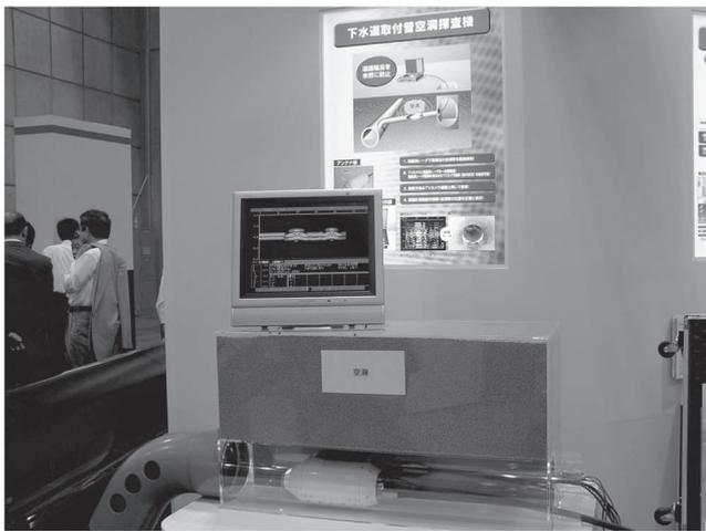
下水道管渠が原因となる道路陥没を未然に防止するため、その原因の大部分を占める取付管の調査を行うTVカメラと空洞調査が同時に行える探査機が展示されていました。この機械のように二つの機能を同時に行えるものは少なく、これからの機器開発のモデルになる可能性を感じました。
