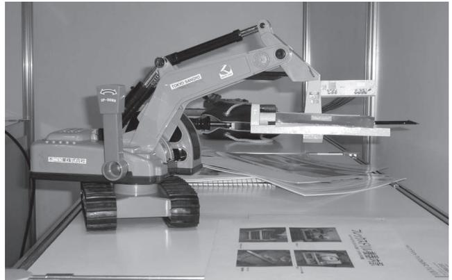
バックホウで立坑を掘る。そのバックホウのバケットの代わりにドリルマシンを取付ける。そのバックホウの油圧を使ってプレリーミングと埋設管引込を行う。ドリルマシン本体もコンパクトながら押し3.6t引力4.7tとパワーも小さめだ。施工延長も土質にもよるが75A、パイプで70mとのこと。ドリルヘッドにはゾンデを埋め込むことも可能で方向修正も出来る。名前はFlexi Drill。ニュージーランド製。そのまま読めばフレキシッドリルであるが日本名は「油圧掘削機アタッチメント式フレックスドリル推進機」である。カタログによれば「50m前後の本支管の敷設に最適な推進機です」とのこと。日本にも既に2台上陸。関東地区あたりで稼働中とのことだ。以前にそんなうわさを聞いたことがあったが・・・展示会場には残念ながらプラモの展示のみ。実機を見てみたいとの問いには、ユーザが頻繁にデモ施工を実施しているとのこと。早速、問い合わせてみようと思う。
