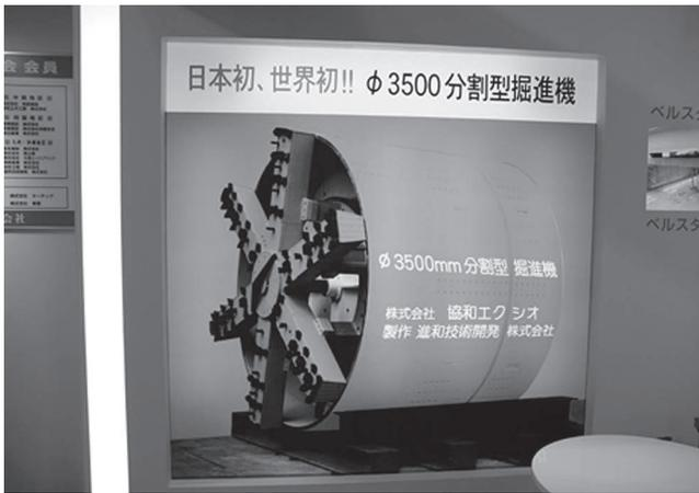
が、進和技術開発(株)・協和エクシオ(株), またもうひとつが、スーパー21協会で、残念ながら実機は無かったのですが(すでに工事が発注され共に使用中とのこと)パネルやパンフレットによると、どちらの掘進機も、道路を運搬する制限と施工完了後に回収を行ない再び次の施工で転用する必要があるなど、推進工法の特徴が発揮できるよう、製作精度や分割方法を工夫した構造となっているようです。
