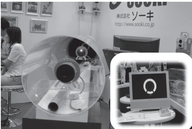
非開削技術においては、地上における土木施工技術と異なり、人が目で見て、触れて施工の状況を確認できないもどかしさがあります。そのため、測量技術に対しても通常の土木施工技術以上に非常に高い精度が、要求され、特に下水道では、“1m先で1mm動いたかどうか?”の精度が要求される技術です。昨今、小口径推進分野では、長距離・曲線施工のニーズが強まるところで今回の下水道展にて気になる計測方法を見つけました。小口径推進工法における測量技術の歴史は、セオドライトによる目視計測方式、レーザセオドライトと機内ターゲットに映し出されるレーザスポットを機内カメラにより確認する計測方式、光ポジションセンサによる自動計測方式、電磁波を利用した地上からの測量方式、レーザ光中継による自動測量方式と年々その技術シーズが、高まっているのが、現状であります。今回の下水道展では、CCDカメラと高度な画像解析技術により、高精度にかつ計測機間隔を長いスパンで計測可能なシステムが、展示されていました。従来より、問題となっていた測量距離が短い間
