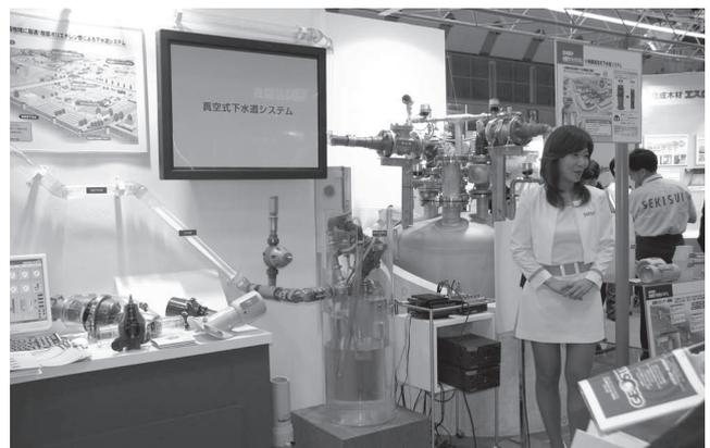
下水道のイメージは自然流下が一般的であるが、発想を転換し、真空で下水を収集するシステムが紹介されていた。泥濃式推進においても流動化した掘削残土は真空で坑外搬出するが、原理はまったく同じである。
