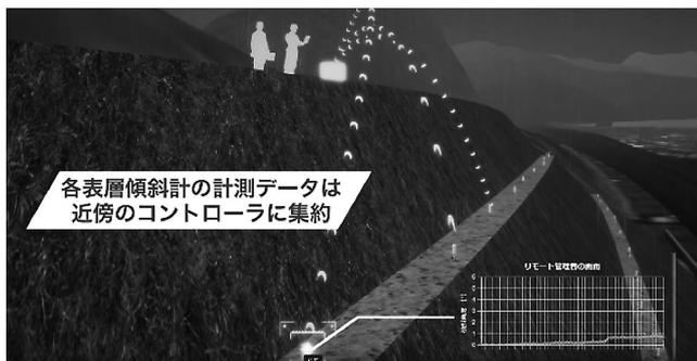
図-9 表層傾斜計による計測モデルの紹介
