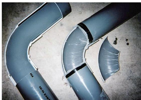
写真-1 反転ゴム使用と未使用の曲管部
