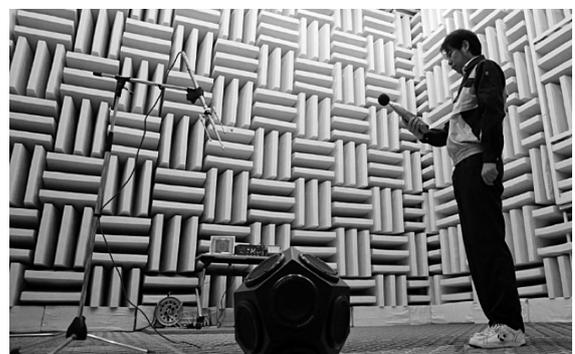
写真-7 音響実験棟無響室での実験状況
