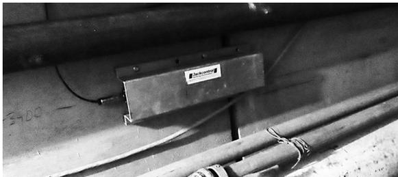
写真-3 応力監視システム用計測装置
