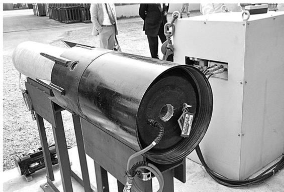
写真-8 止水用のエアボール
