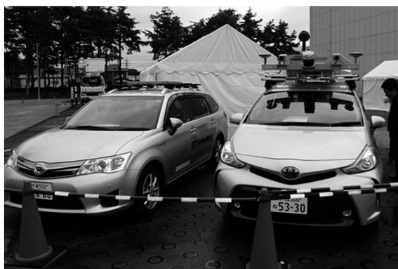
写真-4 MMSを搭載した車
