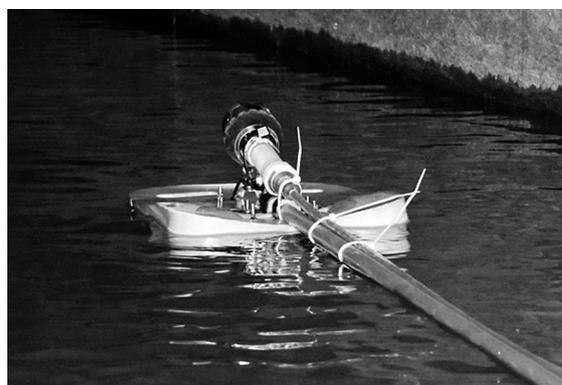
写真-6 カメラを固定したビート板が水路内に押し込まれていく様子
