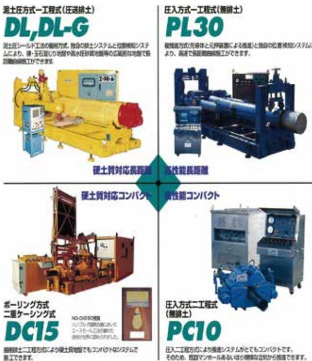
図-1 エースモール工法の種類
